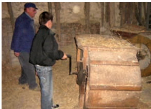
Le tarare est utilisé pour le nettoyage des céréales, après le battage
